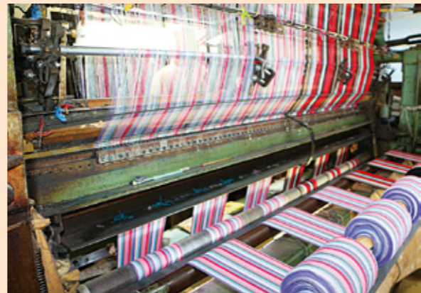
同社が誇るリブ編みは低速ラッセル編み機でしか作ることができない
